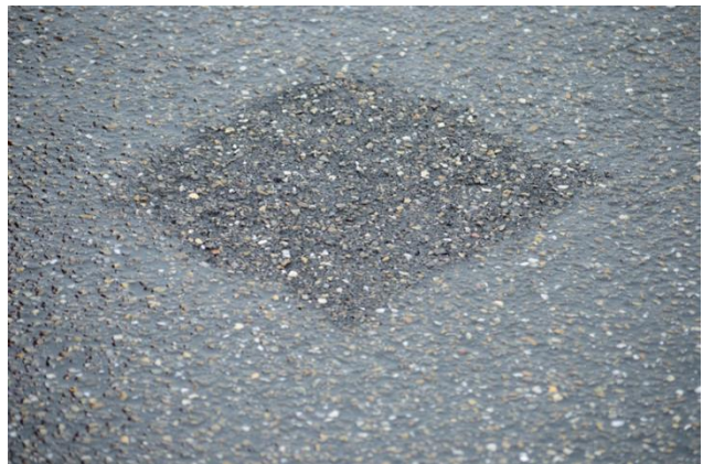
Abbildung 40: Wasserauftrag im Messfeld des DSC111
