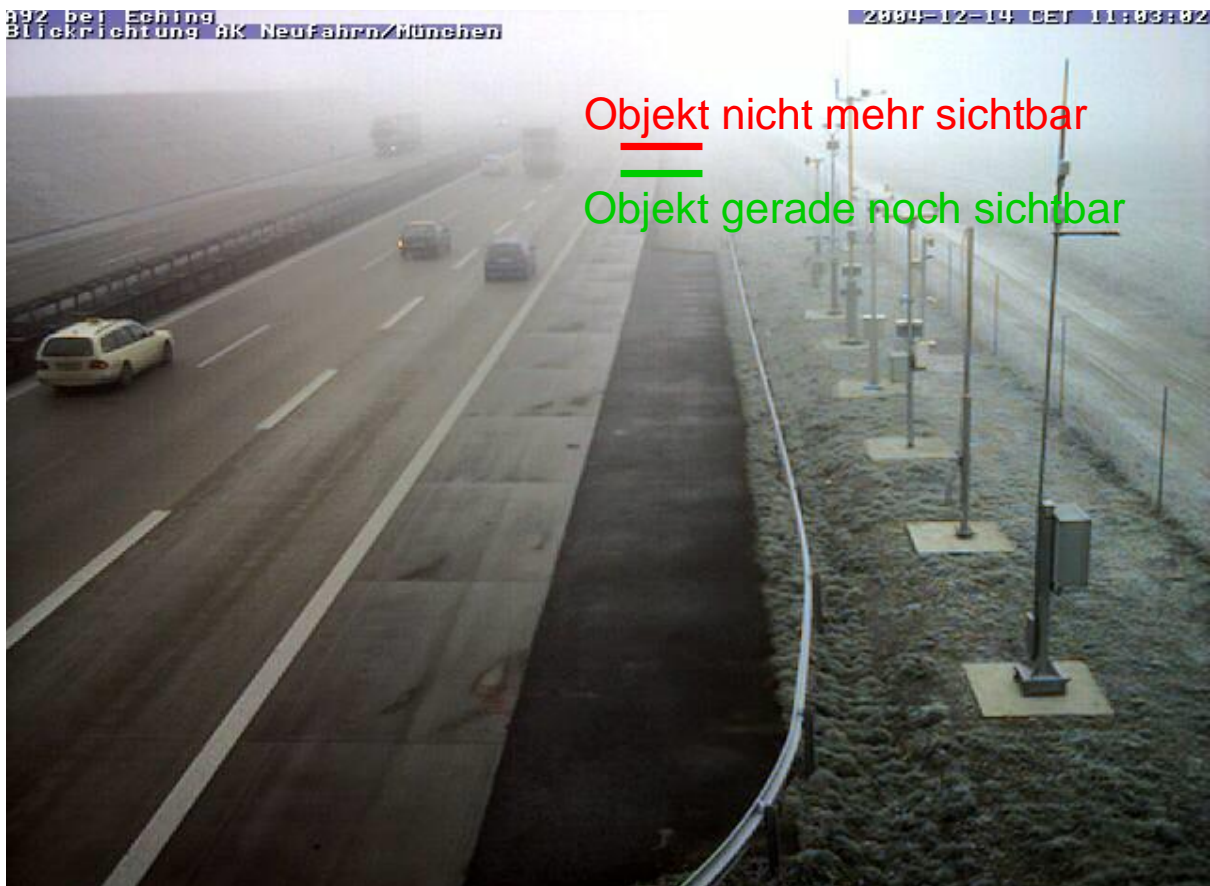
Abbildung 11: Beispiel zur Sichtweitenermittlung mittels Videobeobachtung
