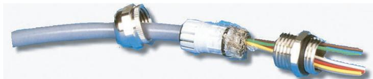
Bitte beachten Sie, dass das Kabel auf der Seite der Datenverarbeitung gegen Feuchtigkeit geschützt ist. Im Allgemeinen wird ein genügender Schutz durch die Verwendung von Pg-Buchsen erreicht, die durch eine Gummidichtung ein Eindringen von Feuchtigkeit in den Klemmraum der Datenverarbeitung verhindern.
